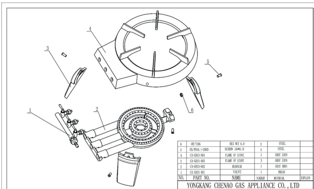
1. Befestigen Sie den Brenner mit Schrauben und Muttern am Rahmen
